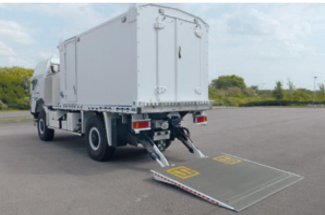
La DH-LMP.20 è dotata di un **telaio molto compatto**, che richiede uno sbalzo 100 mm inferiore al modello standard DH-LM.20. E' particolarmente adatto per autocarri, rimorchi e semirimorchi con **sbalzo particolarmente ridotto** dietro all'asse posteriore o dietro agli attacchi delle sospensioni meccaniche del veicolo (es. autocarri militari, semirimorchi con l'assale posteriore sterzante,...).
